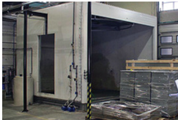
Odmasťovacia a oplachová komora TKS 045.OOK
